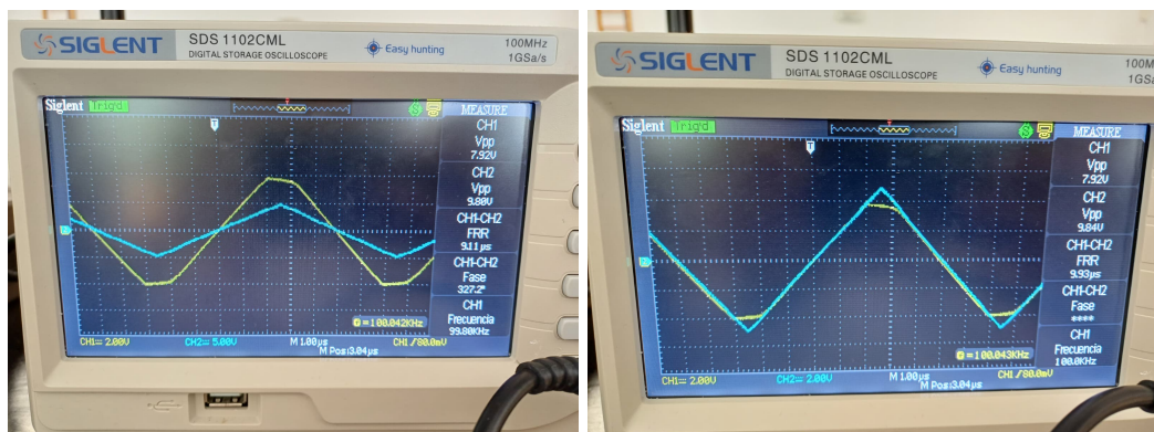
Figure 6: Sinal triangular para terminal en aberto
